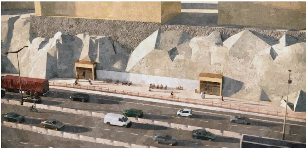
Figur 36: Visualisering av den nordliga hållplatsentrén mot Stigbergskajen och Oscarsleden (E45) som kan utformas som två in-/utgångar bredvid varandra. Illustration: AFRY
